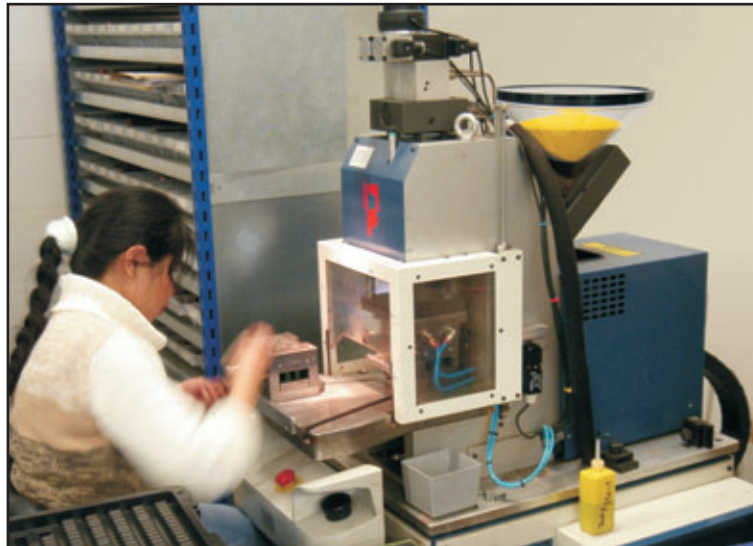
Praxisbeispiel: Manuelle Bestückung eines 2-reihigen Steckverbinders
