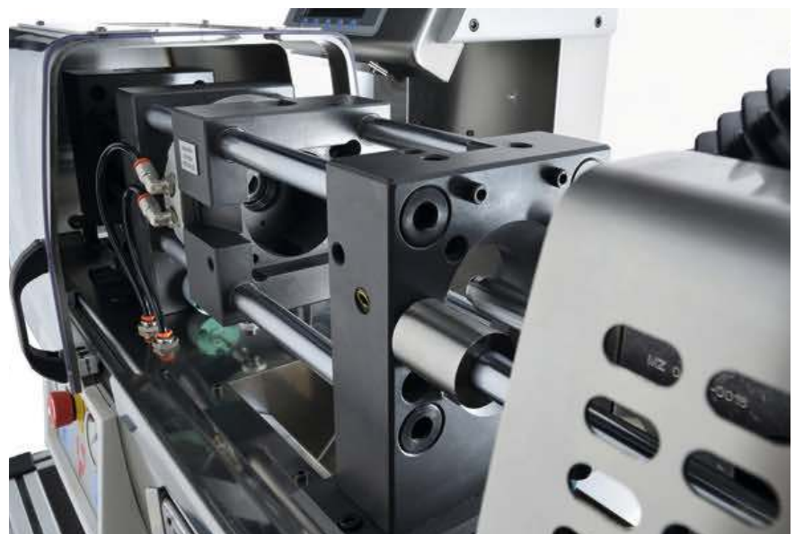
Für anspruchsvolle Anwendungen im Reinraum ist die babyplast-Maschine optional in Edelstahlausführung erhältlich (Bild: Christmann Kunststofftechnik)
